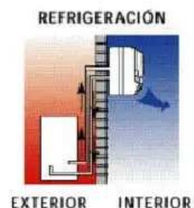
El sistema de climatización funciona como una nevera, que extrae continuamente calor del interior y lo descarga en la cocina. Este calor "gratuito" puede notarse tocando el serpentín de la parte trasera de la nevera.
